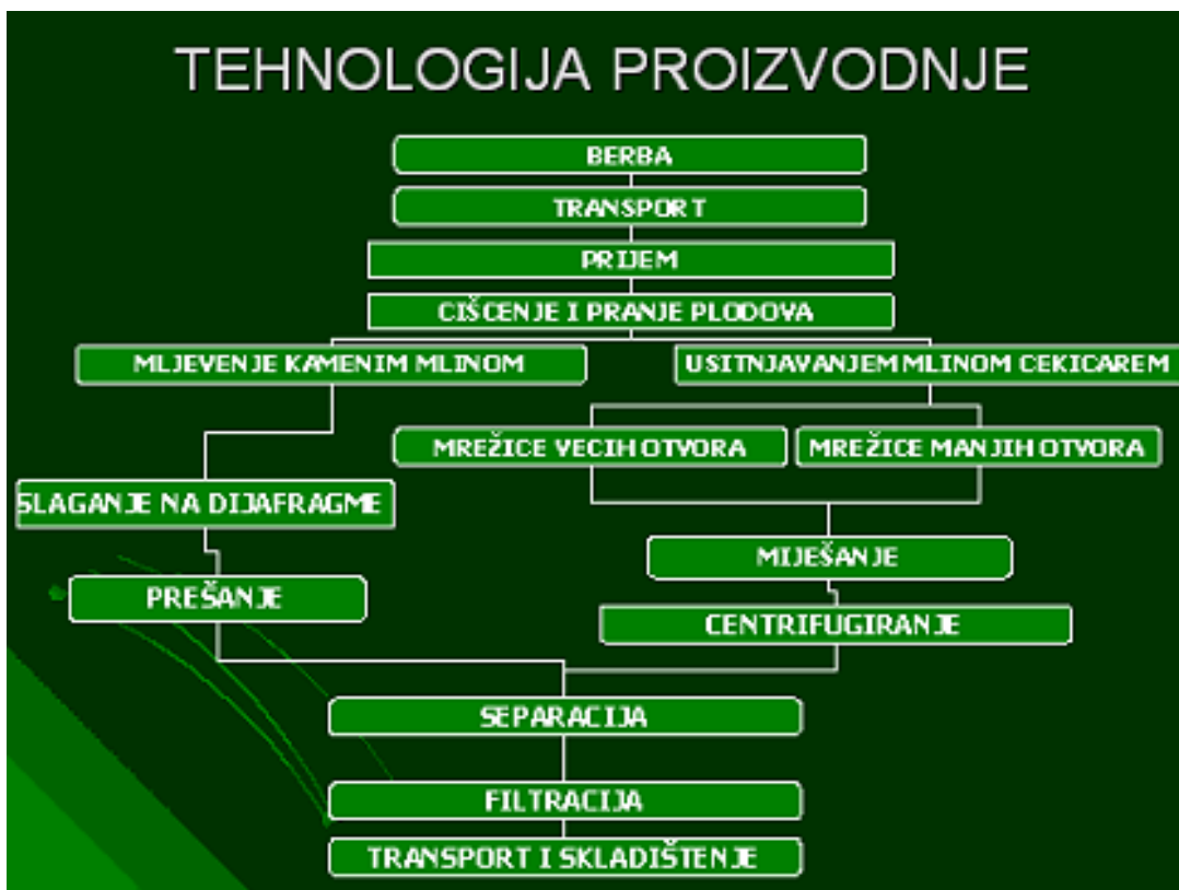
Slika 4. Blok shema proizvodnje maslinovog ulja
