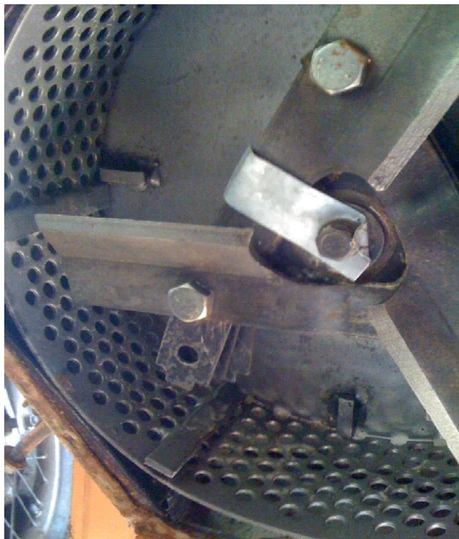
Slika 7. Mlin čekičar (metalni mlin)
