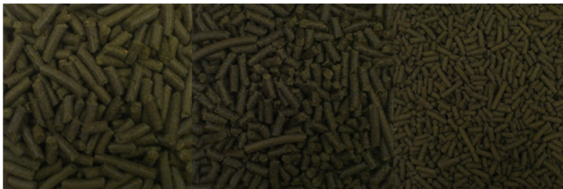
a) b) c) Slika 20. Pogača industrijske konoplje a) Ø12 b) Ø9 c) Ø6
