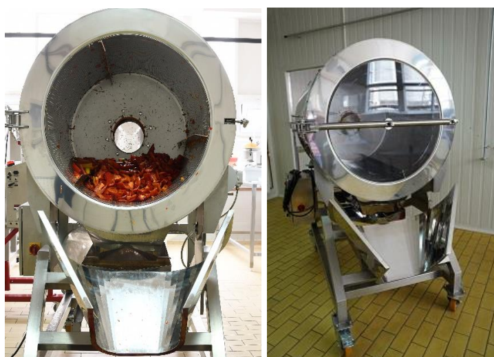
Slika 6 Laboratorijski prototip uređaja za izdvajanje sjemenki paprika (CROTEH d.o.o., 2021.) (Izvor: Podravka d.d.)
