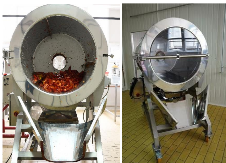
Slika 6 Laboratorijski prototip uređaja za izdvajanje sjemenki paprika (CROTEH d.o.o., 2021.) (Izvor: Podravka d.d.)
