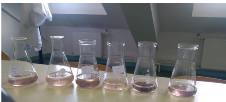
Slika 1. Određivanje sadržaja SO 2 u vinu titracijom
