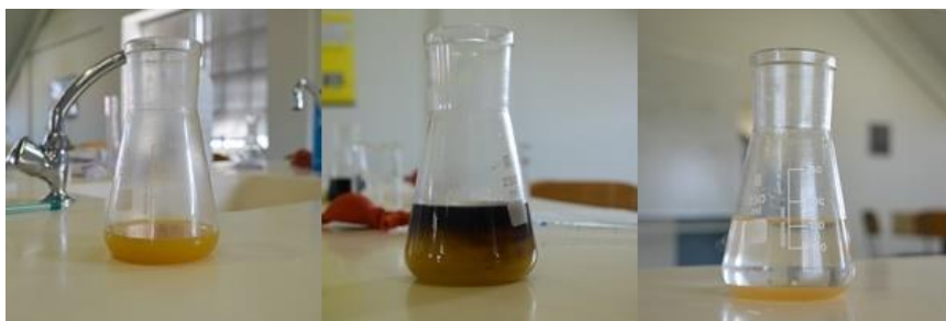
Slika 3. Određivanje peroksidnog broja (Izvor: autor)
