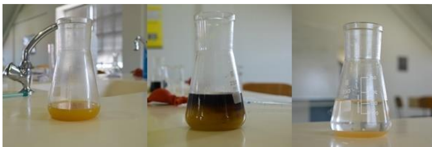
Slika 3. Određivanje peroksidnog broja (Izvor: autor)
