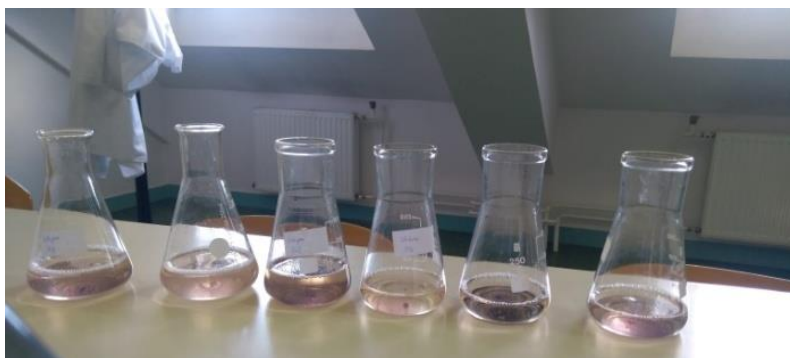
Slika 1. Određivanje sadržaja SO 2 u vinu titracijom
