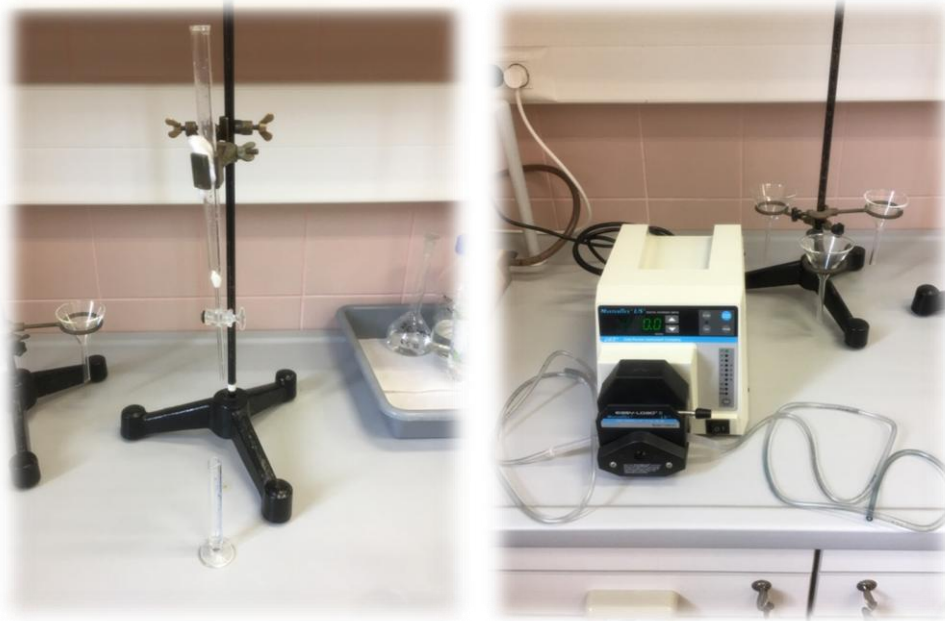
Slika 7 Sustav za ispitivanje adsorpcije arsena u koloni
