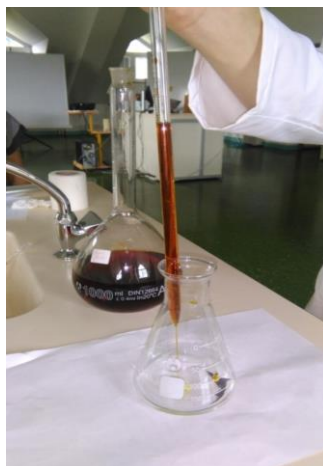
Slika 11. Prikaz titracije standardne otopine vitamina C Fig. 11. Titration of vitamin C standard solution
