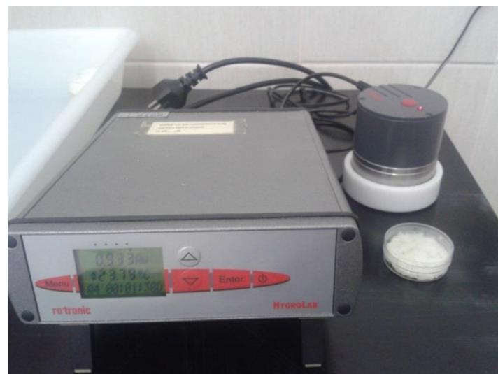
**Slika 16** HygroLab 3 (uređaj za određivanje aktiviteta vode)
