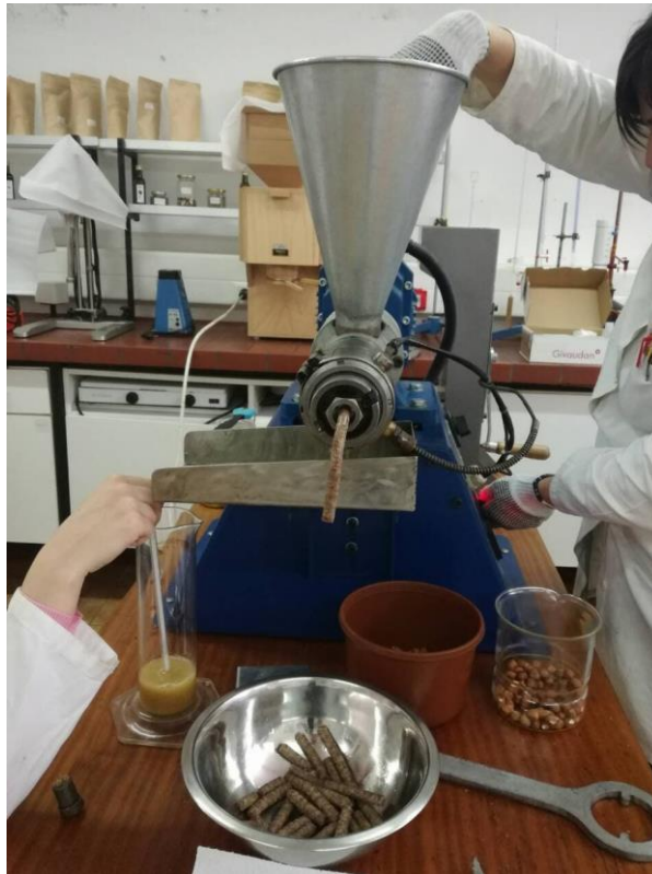
Slika 8 Mjerenje volumena i temperature sirovog ulja tijekom prešanja
