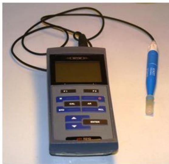
**Slika 18** Prijenosni pH metar pH 3210/3310 tvrtke WTW
