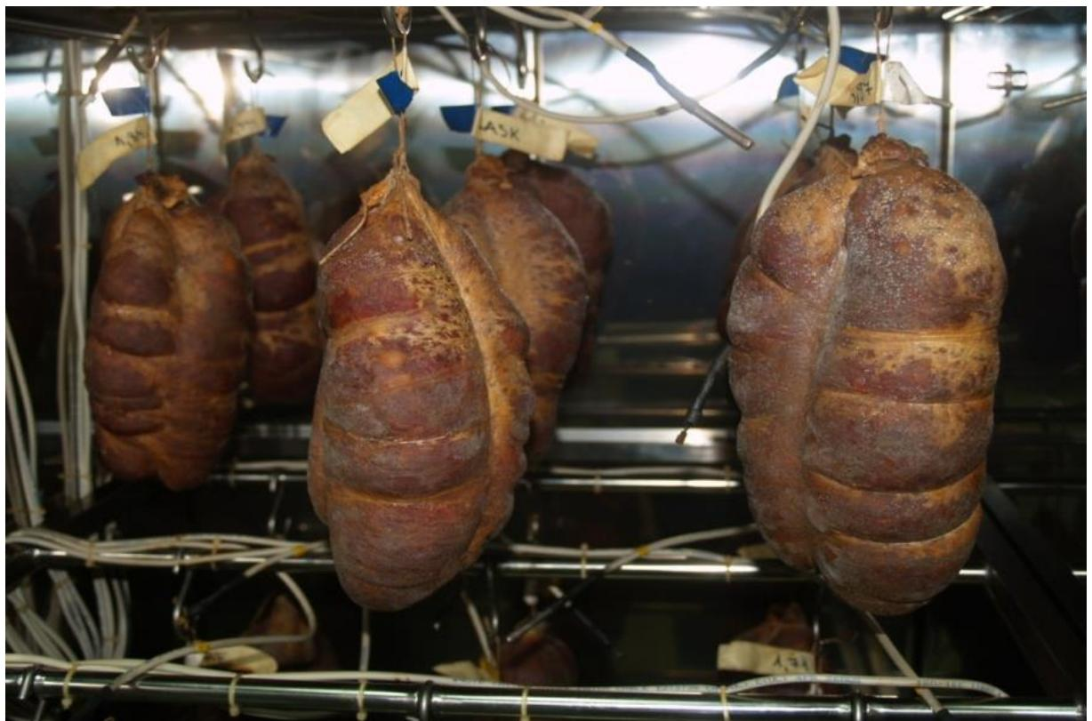
**Slika 2** Zrenje kulena u automatiziranoj komori za zrenje
