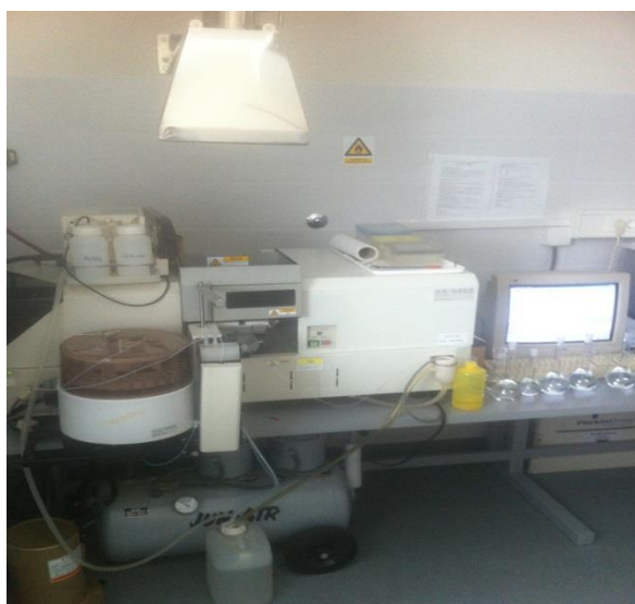
Slika 4 AAS spektrometar, plamena tehnika
