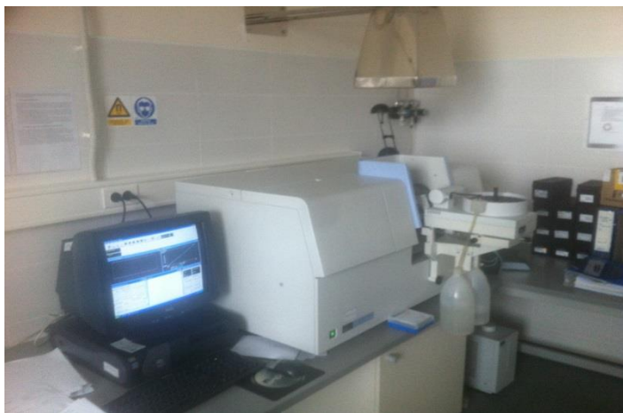
Slika 5 AAS spektrometar, grafitna tehnika
