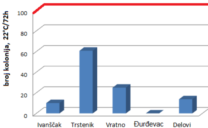
Slika 15 Grafički prikaz srednjih vrijednosti broja kolonija na 22°C u uzorcima vode iz pojedinih izvorišta, uz istaknutu MDK vrijednost
