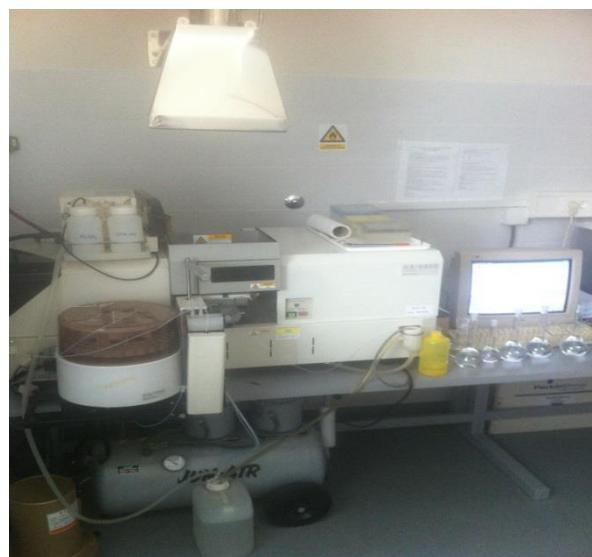
Slika 4 AAS spektrometar, plamena tehnika
