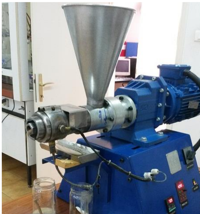
Slika 11 Pužna preša za proizvodnju hladno prešanog ulja iz koštica marelice
