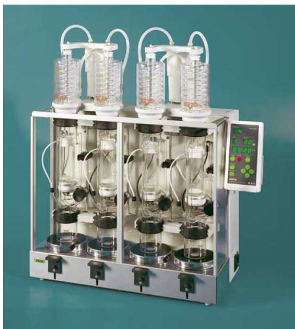
Slika 3.2. Univerzalni sustav za ekstrakciju (Büchi B-811_LSV)
