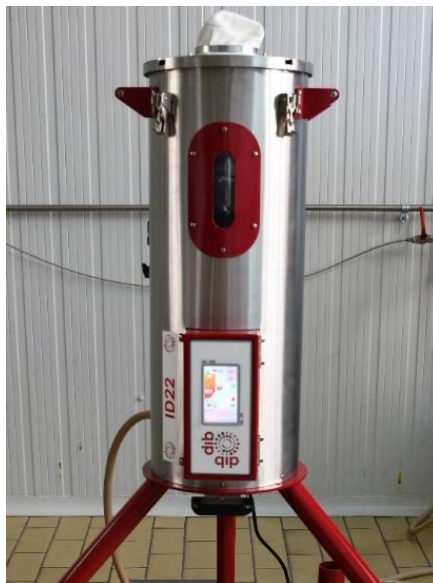
Slika 7 Sušenje i sterilizacija sjemenki paprike 2021. (Izvor: Podravka d.d.)
