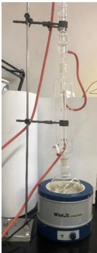
Slika 4 Aparatura po Clevenger-u (Izvor: Autor)
