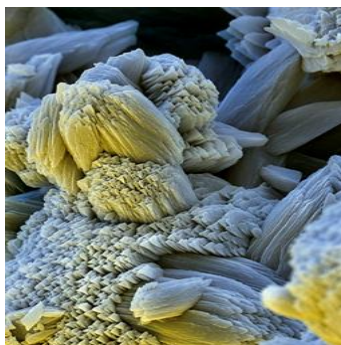
Slika 2. Kamenac snimljen elektronskim mikroskopom (vidno polje je 64x90 μm)
