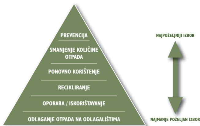
Slika 2. Shematski prikaz reda prvenstava u gospodarenju otpadom (Medven i sur., 2009.) Fig. 2. Scheme representation order of priority in waste management (Medven and et al., 2009.)
