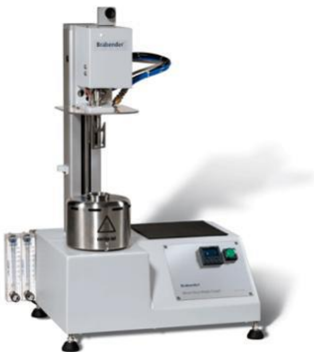
Slika 9 Brabenderov Mikro visko-amilograf (Jozinović, 2015)
