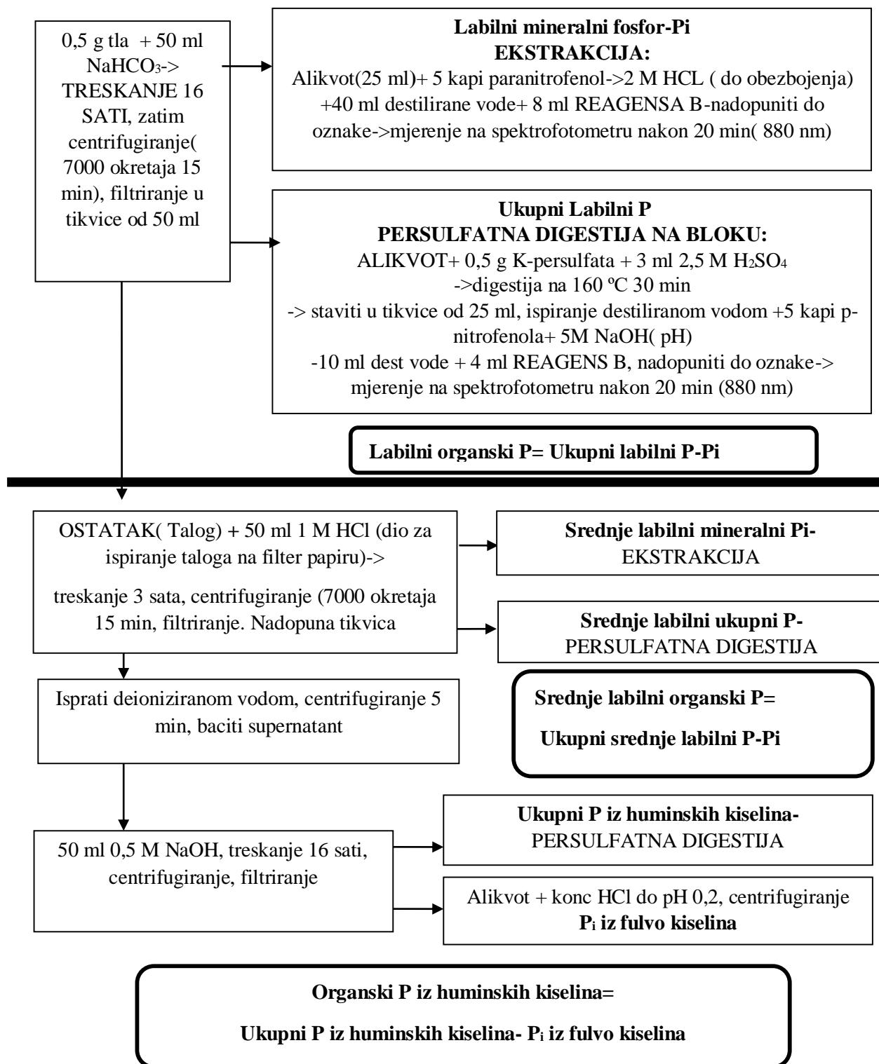
Shema 1. Shematski prikaz postupka određivanja koncentracije organksog fosfora u tlu
