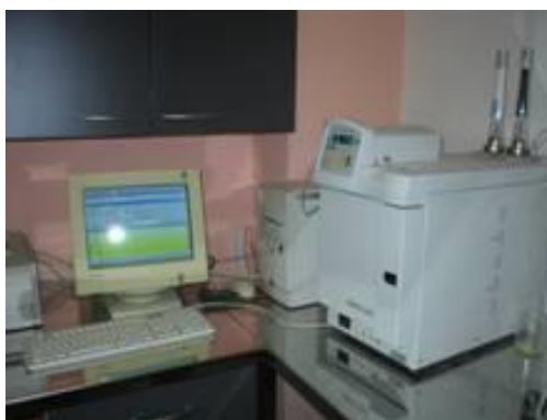
Slika 10. Analizator bioplina plinski kromatograf Varian 3900
