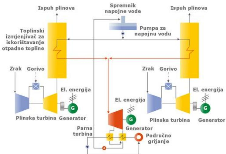
Slika 18.: Načelna shema rada kogeneracijskog postrojenja
