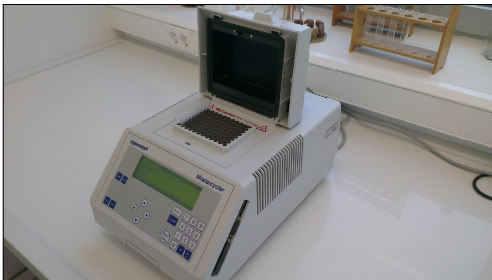
Slika 5. Uzorci u uređaju za PCR analizu (foto original; S. Guberac)
