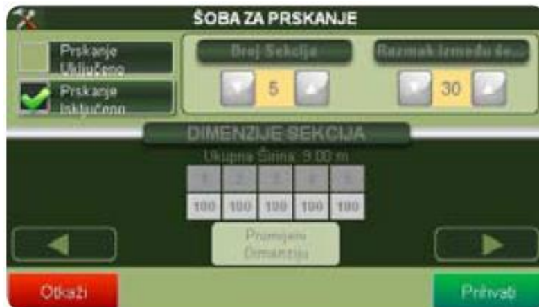
Slika 8. Izbornik Šoba za prskanje (G6 Farmnavigator priručnik za korisnike)
