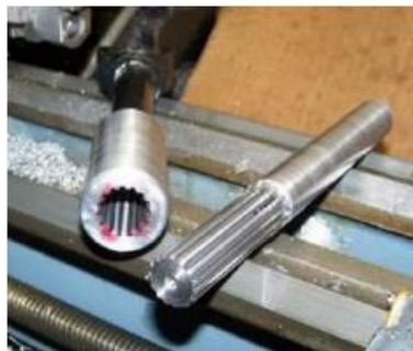
Slika 24. Obradak i alat kod provlačenja (Slade, 2004.)
