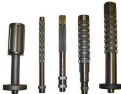
Slika 21. Dugačke igle (vučeni alati) (Slade, 2004.)
