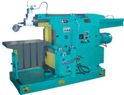
Slika 19. Kratkohodna hidraulička blanjalica
