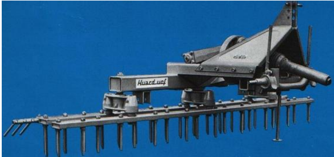
Slika 22. Oscilirajuća drljača (Lukač i sur., 2017)
