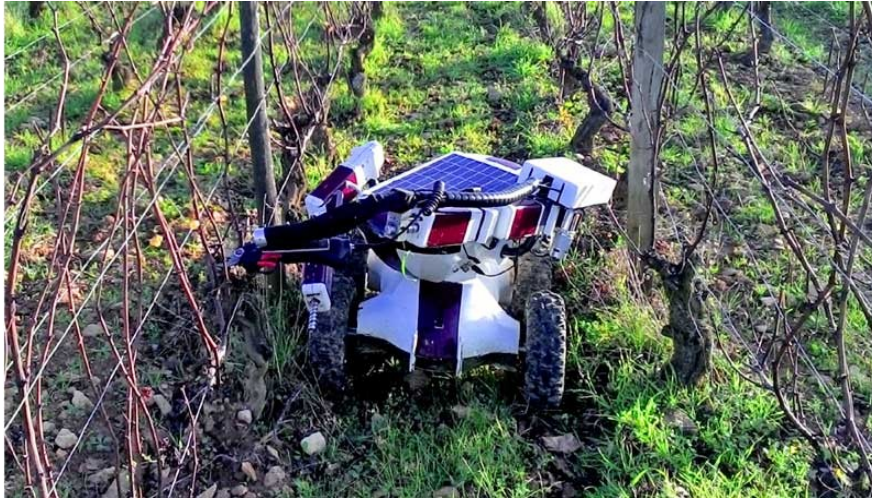
Slika 26. Wall-Ye 1000 Pruning Robot
