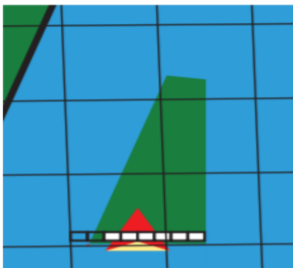
Slika 14. SC Standard Inteligentno raspodjeljivanje na nepravilnim rubovima
