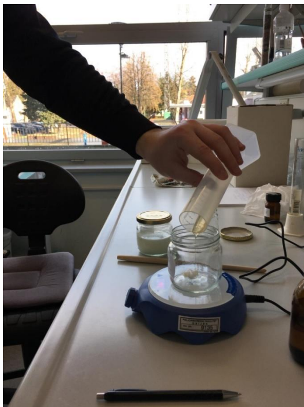
Slika 6. Emulgator polisorbatTween®80 dodan kap po kap u staklenu posudu i miješan magnetskom miješalicom u trajanju od 10 min.
