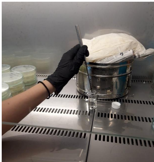
Slika 3. Hlađenje pribora u destiliranoj vodi Izvor: Dujković, 2019.
