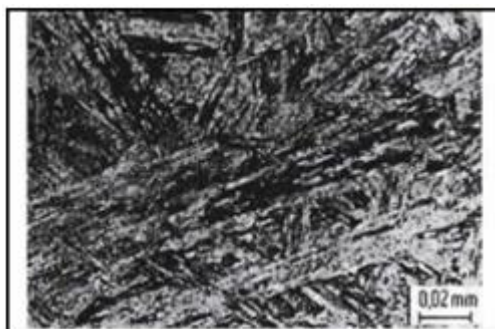
Slika 6. Mikrostruktura martenzitnog nehrđajućeg čelika
