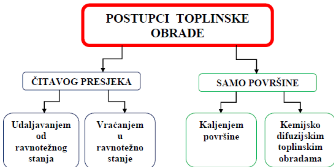
Slika 8. Podjela postupaka toplinske obrade (Izvor: Gabrić i Šitić 2015.).
