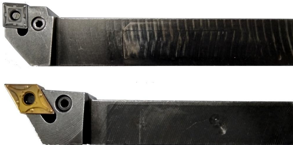
Slika 12. Lijevi nož za vanjsko grubo (gore) i fino tokarenje (dolje) (Izvor: autor)
