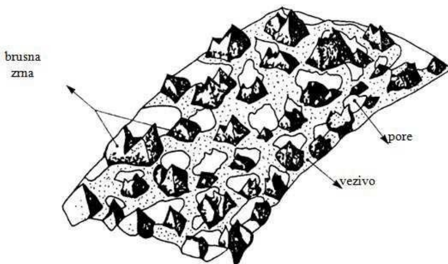
Slika 18. Rezna površina brusne ploče (Izvor: Ciglar, 2018.)
