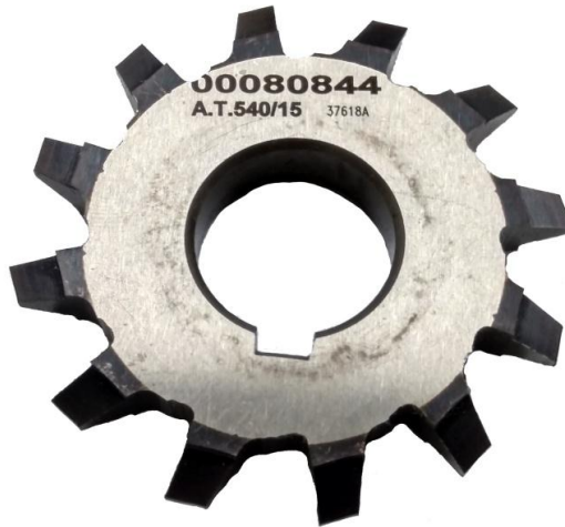
Slika 24. Glodalo za izradu zavoja pužnog vratila (Izvor: autor)
