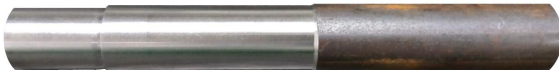
Slika 14. Pužno vratilo motokultivatora nakon prve operacije tokarenja (Izvor: autor)
