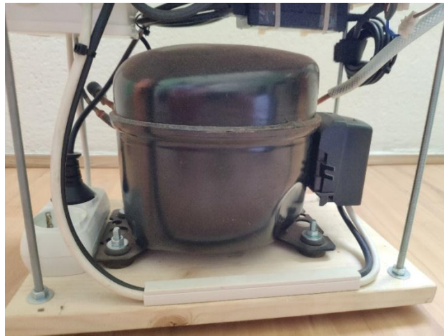
Slika 12. Vakuum crpka-kompresor, prednja strana
