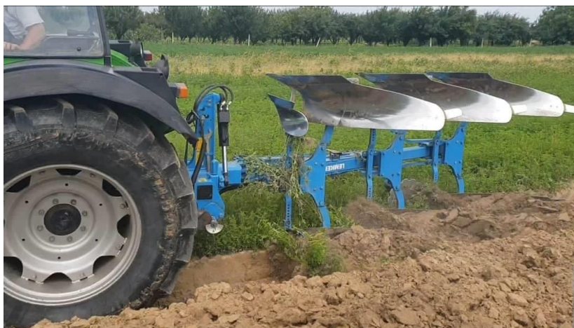
Slika 2. Obrada tla plugom premetnjakom (Izvor: vlastita fotografija)
