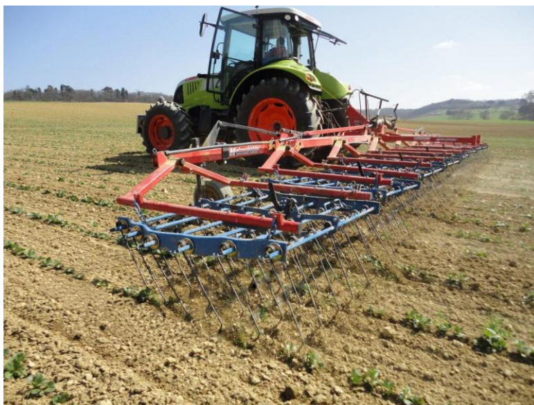
Slika 13. Pljevilica marke „Hatzenbichler“ u radu (Izvor: www.hatzenbichler.com )
