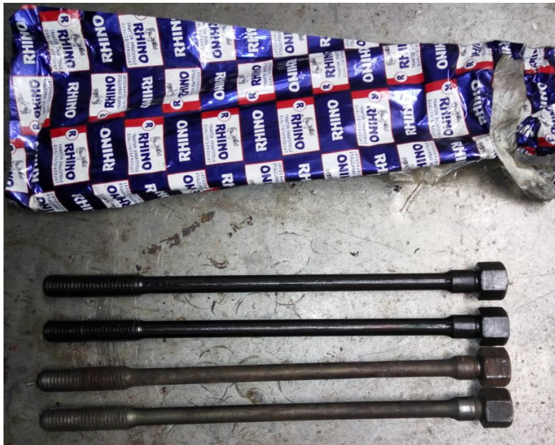
Slika 17. Elastični vijci cilindarske glave (izvor: autor)
