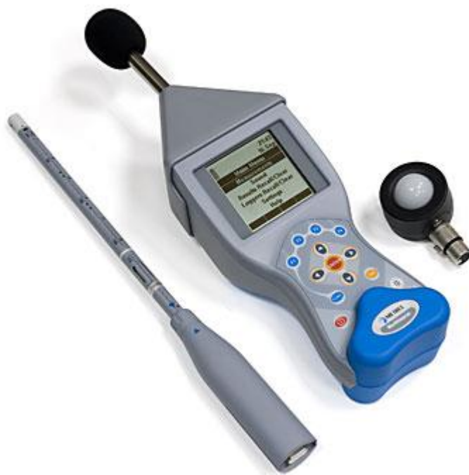
Slika 4. Uređaj za mjerenje buke Metrel Multinorm MI 6201 EU
