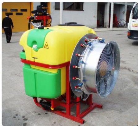
Slika 23. Zaštitni lim i ventilator raspršivača izrađen od legiranog aluminijskog lima ( http://lesko.hr/?page_id=434 )
