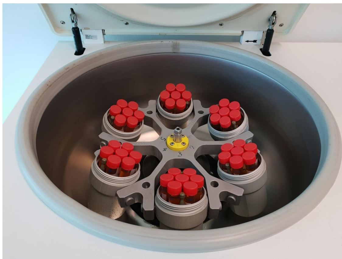
Slika 9. Kivete s otopinama u centrifugi (Izvor: autor)
