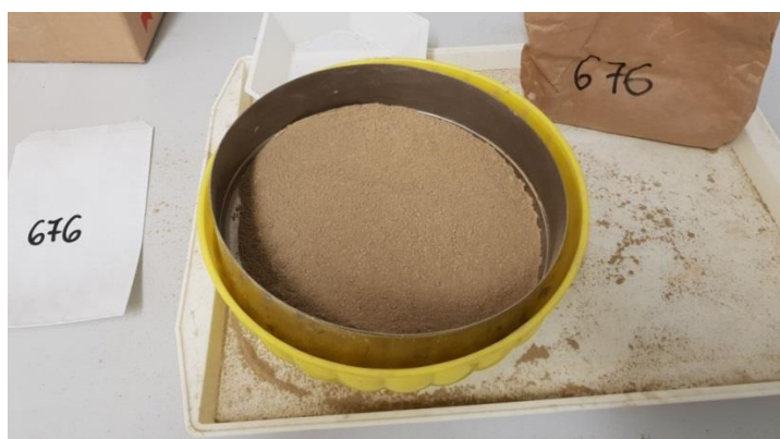
Slika 4. Prosijavanje uzorka (Izvor: autor)
