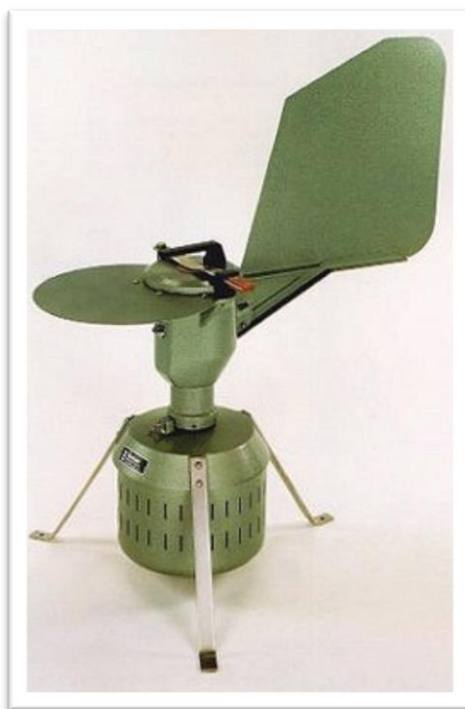
Slika 5. Klopka za pelud i spore "Burkard 7-day volumetric spore trap"
