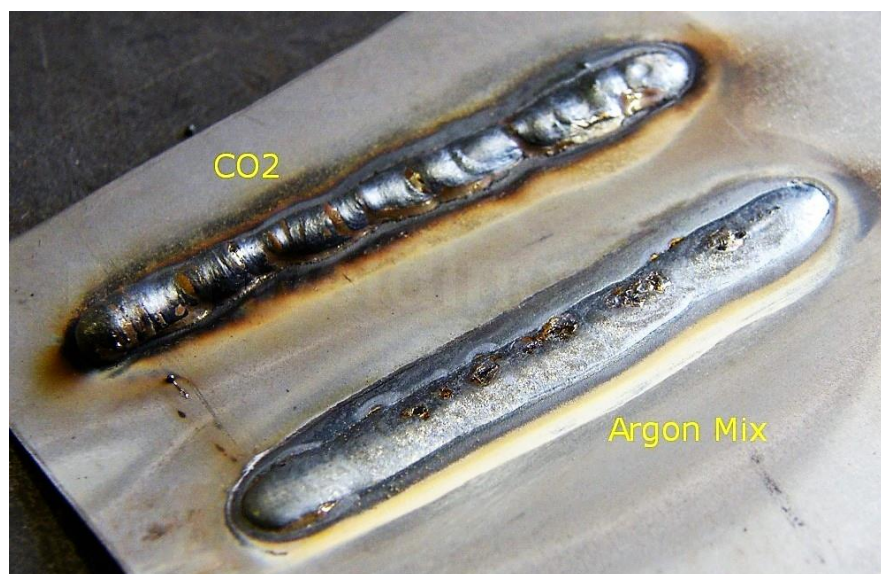
Slika 16. Usporedba izgleda zavara dobivenih MIG i MAG postupkom (Izvor: http://www.mig-welding.co.uk/gas/co2-vs-argoshield-thin.jpg )
