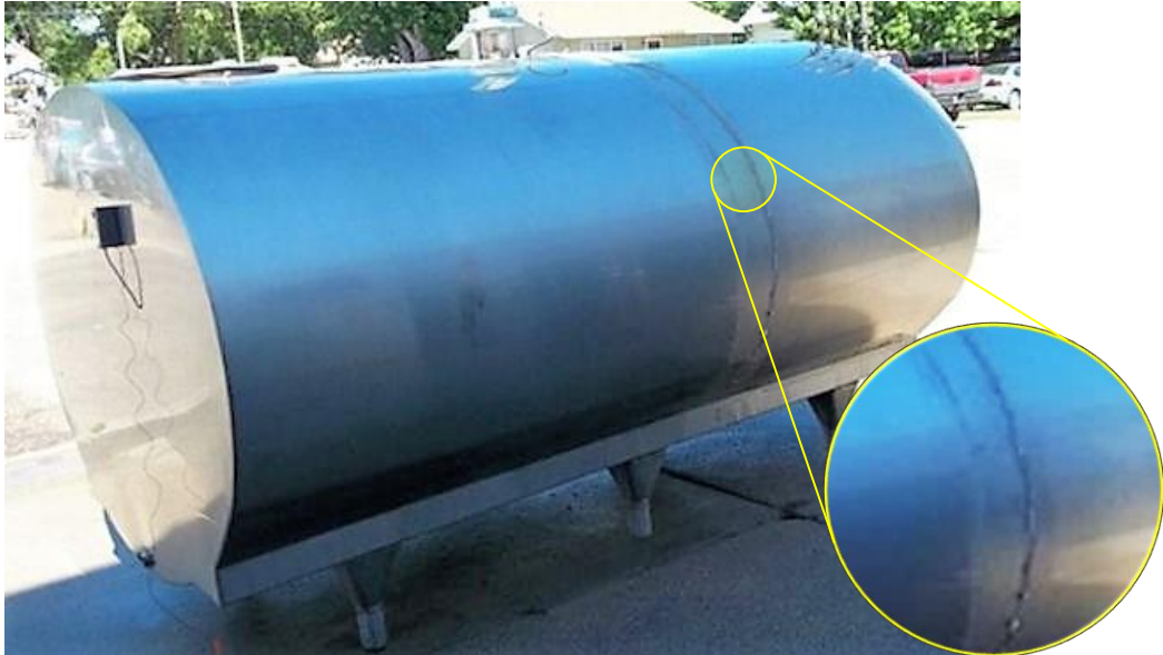
Slika 23. Reparaturno zavarivanje spremnika za mlijeko (Izvor: http://www.schiercompany.com/FarmTanks.html )
