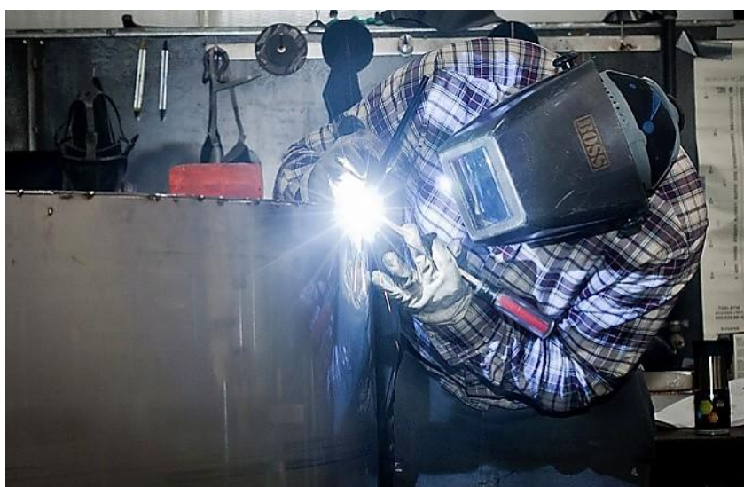
Slika 28. Popravak nehrđajuće posude u proizvodnji vina (Izvor: http://www.thedalleschronicle.com/news/2015/mar/28/wine-and-steel/ )
