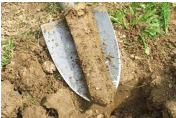
Slika 2. Uzimanje uzoraka lopatom
