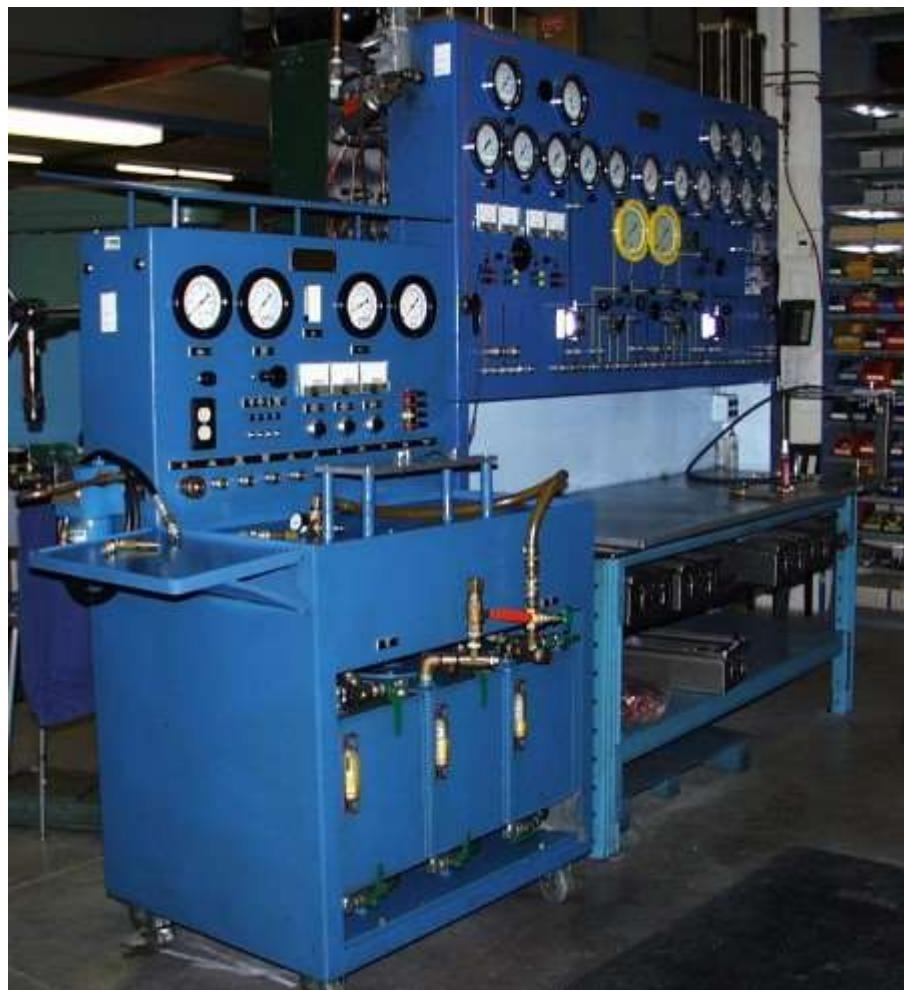
**slika 17. oprema za pneumatski test** ([www.pmc-controls.com](http://www.pmc-controls.com))
