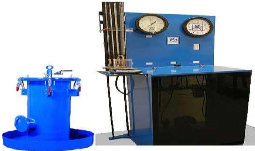
**slika 16. oprema za hidrostatski test** ([www.hidrotest.com](http://www.hidrotest.com))
