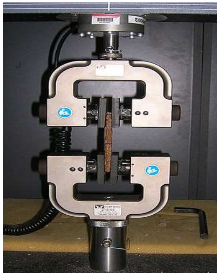
slika 4. univerzalna kidalica ( www.cmk.vuka.hr )
