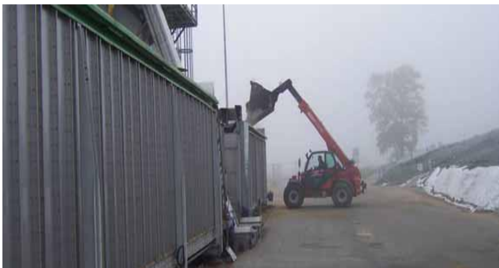
Slika 19. Utovarivač puni spremnik (kontejner) kukuruznom silažom.
