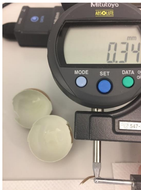
Slika 20. Mjerenje debljine ljuske jaja (foto: Fazaneriya Božur)
