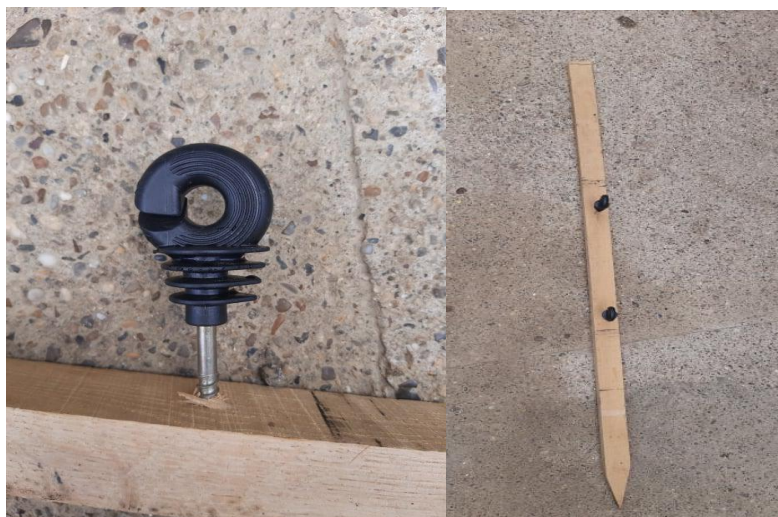
Slika 12. Izolator i izgled izolatora na stupčiću (Dodigović M., travanj, 2021)
