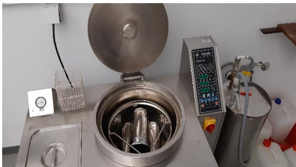
Slika 1. Petrijeve zdjelice u aluminijskim stalcima u autoklavu
