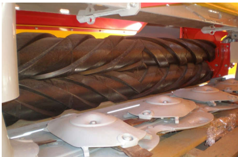
Slika 7. Unutrašnjost kosilice - gnječilice s valjcima „SIP“ (link 4.)
