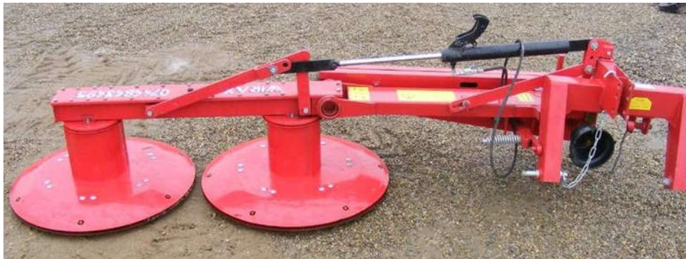
Slika 5. Radni organi rotirajuće travokosilice („SIP")
