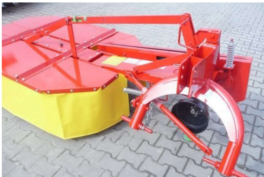
Slika 6. Kosilica-gnječilica „SIP SILVERCUT DISC 270 S RC“
