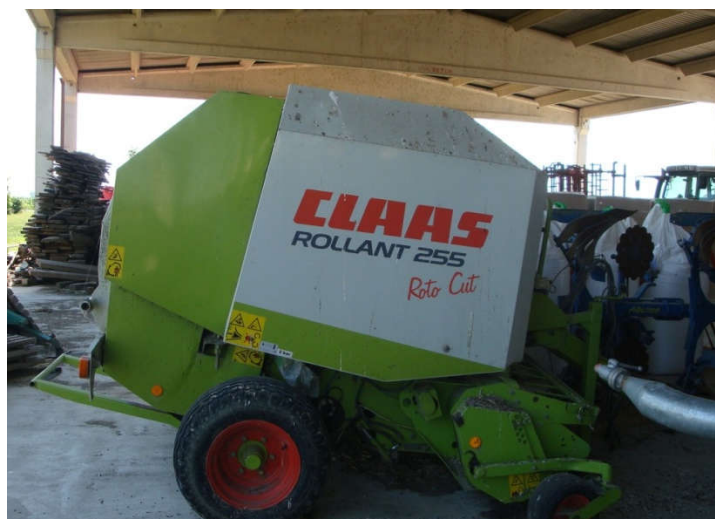
Slika 11. Preša Claas Rollant 255 Roto Cut za valjkaste bale
