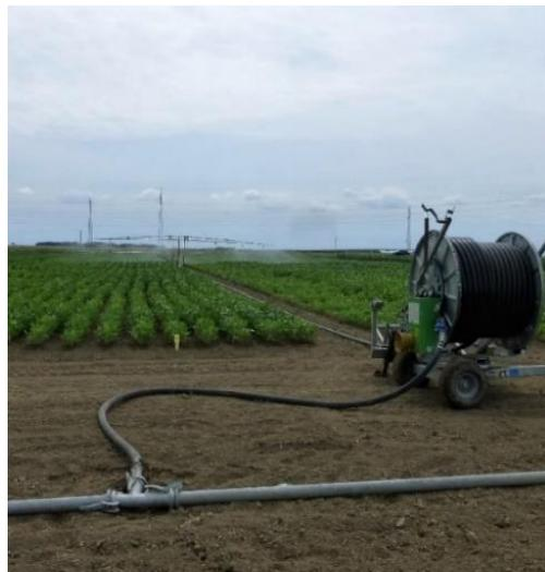
Slika 3. Navodnjavanje parcela samohodnim rasprskivačem s kišnim krilom
