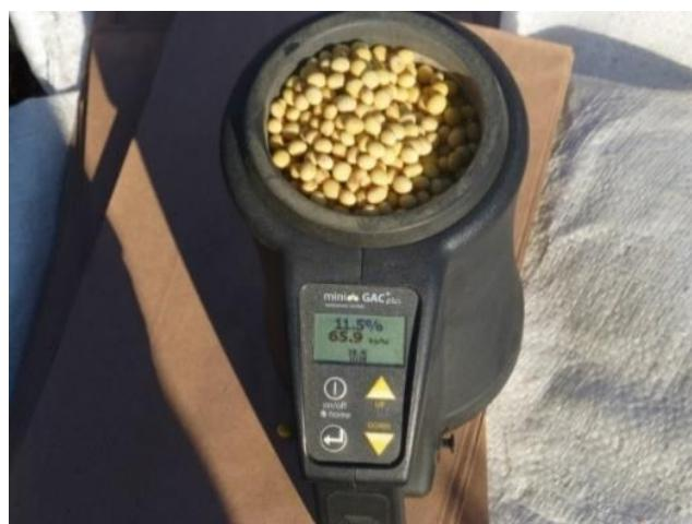
Slika 11. Mjerenje vlage i hektolitarske mase uređajem *Dickey John*
